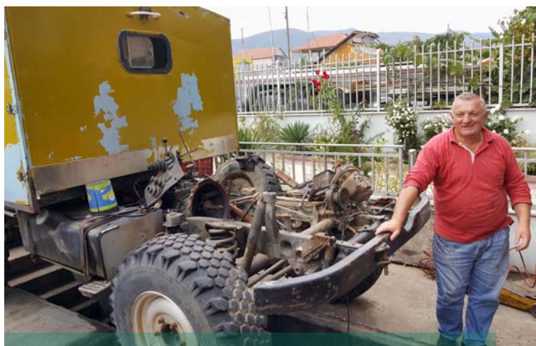
Unser Unimog – unverzichtbar für die Fahrten in die Bergdörfer – brauchte ebenfalls eine neue Kupplung; dazu musste das Fahrerhaus komplett abgebaut werden
